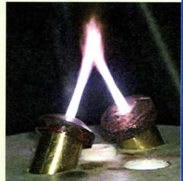
Самофокусирующаяся углеродная дуга в открытом пространстве
