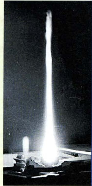
Самофокусирующаяся углеродная дуга в открытом пространстве
